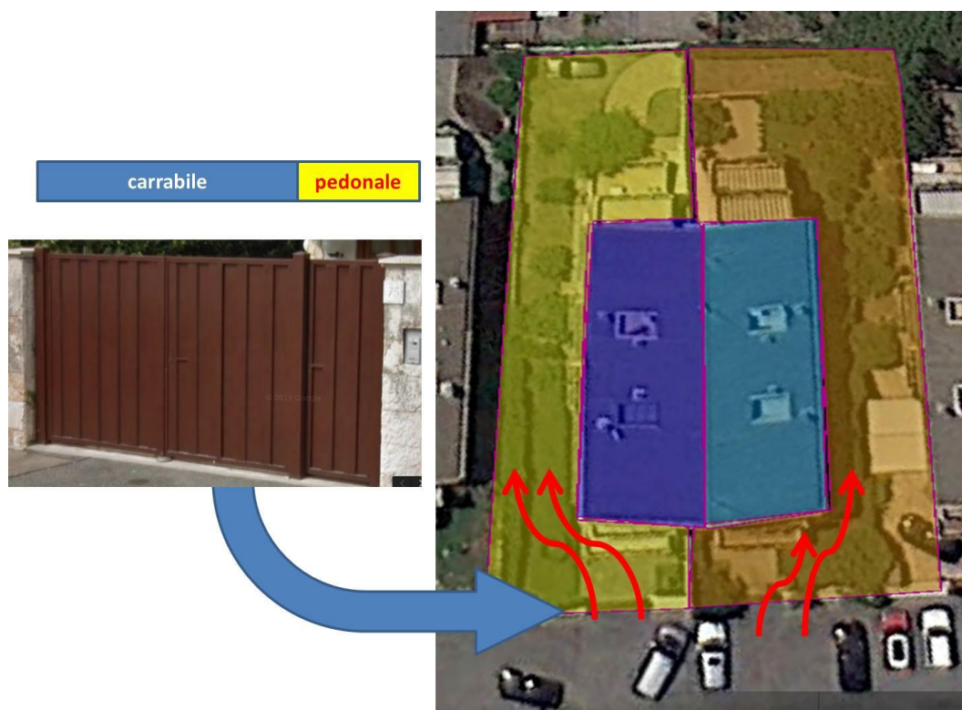
Figura 23 - Esempio di accessi pedonali e carrabili contigui che immettono su un unico livello. Pianta su Via Genovese Zerbi, Comune di Roma - Fonte Elaborazione su Google Earth
